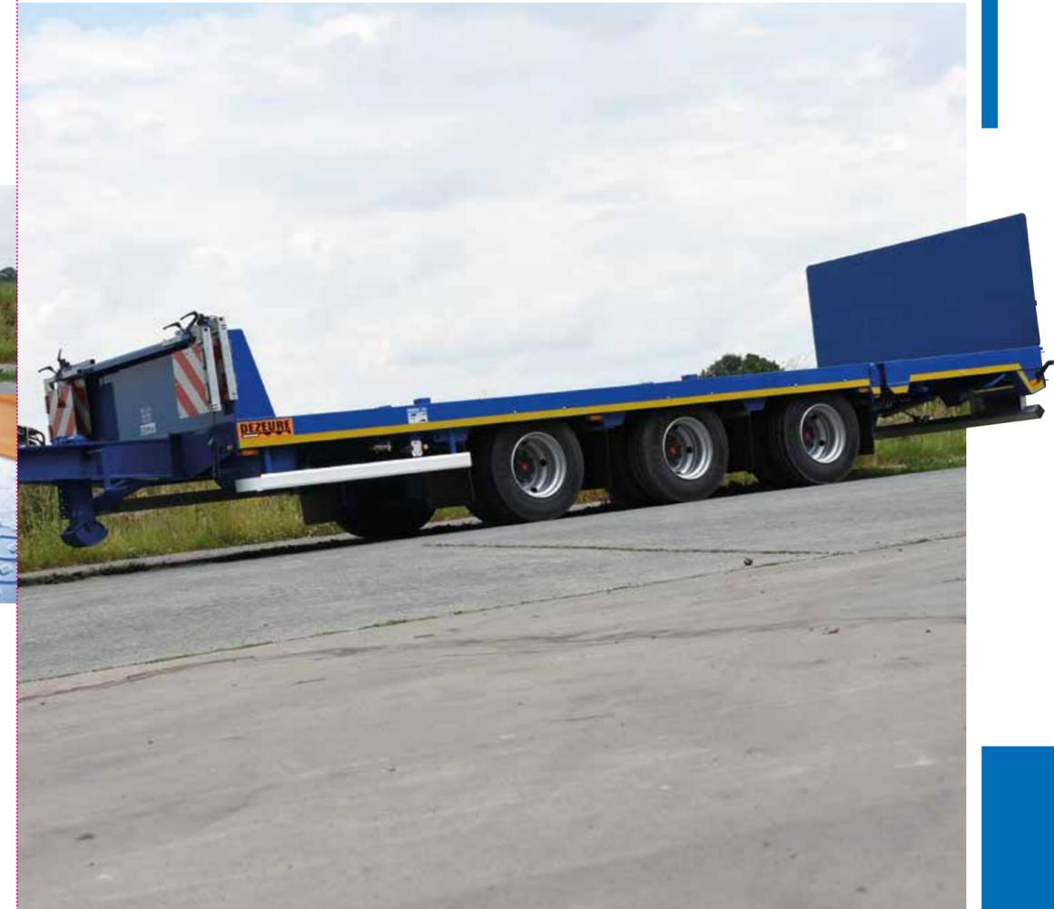
Bij de ADW modellen staan de assen centraal dit zorgt voor een uiterst **handige** en **wendbare** dieplader. Het lucht geveerde onderstel zorgt voor een uiterst **comfortabel** rijgedrag. Dankzij deze ophanging kun je onder een **kleinere oprijhoek** laden. Verschillende uitvoeringen van de laadvloer zorgen voor een **multifunctionele** inzetbaarheid. Op de modellen ADW gebruiken we enkel assen van een A merk, dit garandeert de **bedrijfszekerheid**.
